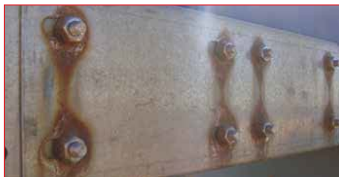
Esempio di corrosione galvanica dovuta dall'accoppiamento di dadi e bulloni in acciaio INOX su una piastra in acciaio.
